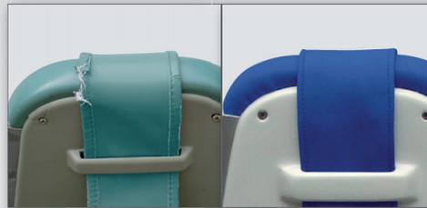
Reparatur im Einzelteileaustausch: z. B. die Kunststoffverkleidung der Rückenlehne.
