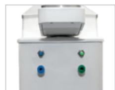
Schnellkupplung für Luft und Wasser, Fremdgerät
